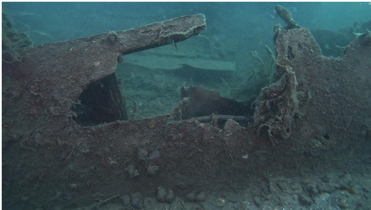
Figura II.II.9 -10 – Carlinga con tracce di esplosione, lato sinistro (elab. G. Bucci da screenshot video GC – Immagine su concessione MiC – SABAP-RA).
