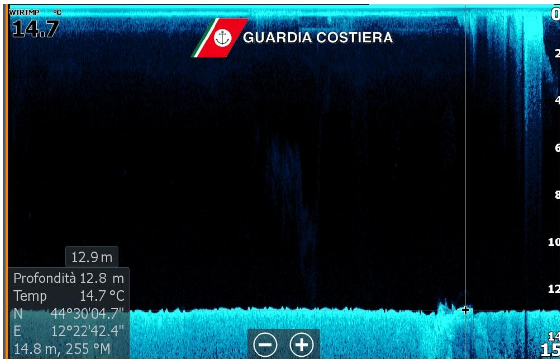
Figura II.II.4 – 4 -- Down image da Side-scan sonar : a destra, il relitto (Guardia Costiera, 25/03/2024 - Immagine su concessione MiC – SABAP-RA).
