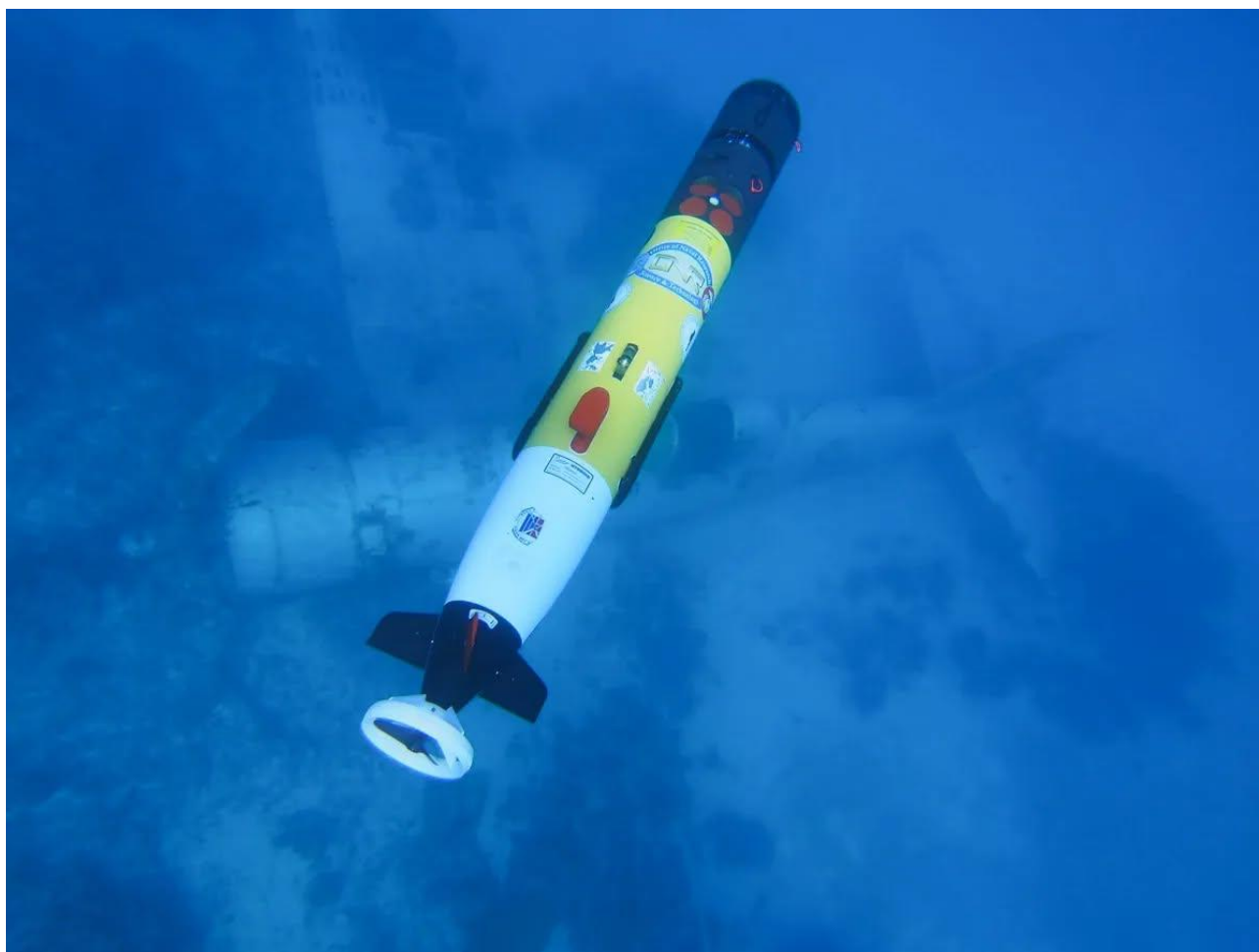
Figura I.2.7 - 3 – AUV in scansione sopra relitto di velivolo (© Project Recover).
