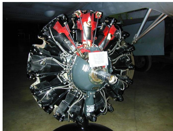
Figura II.II.8 – 10 – USAF Museum, Dayton, Ohio, parte frontale del motore Cyclone Wright R 1820; al di sotto del mozzo dell'elica si vedono una targhetta rettangolare piatta e una curva fissata sul carter dell'olio, in basso (da https://upload.wikimedia.org/wikipedia/commons/7/72/Wright_R-1820_Engine.jpg CC BY-SA 3.0, accesso 30/10/2025).
