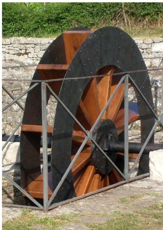
Fig. 3. Ricostruzione di una ruota idraulica romana.
