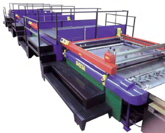
Figura 4.9: Dispositivo per stampa serigrafica di lastre piane
