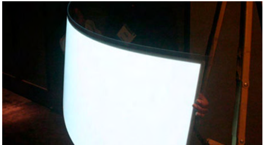
Figura 5.97: un altro esempio di foglio flessibile OLED
