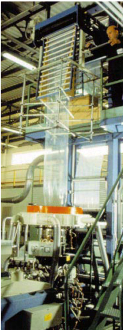
Figura 4.4: Uno dei processi di produzione dei film in Polietilene (fonte: SNIA)
