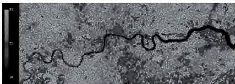
Fig 03: l'immagine rappresenta l'isola di calore della città di Londra, dove le parti più scure, parchi e Tamigi, rappresentano le zone con temperature inferiori (fonte: CESA)
