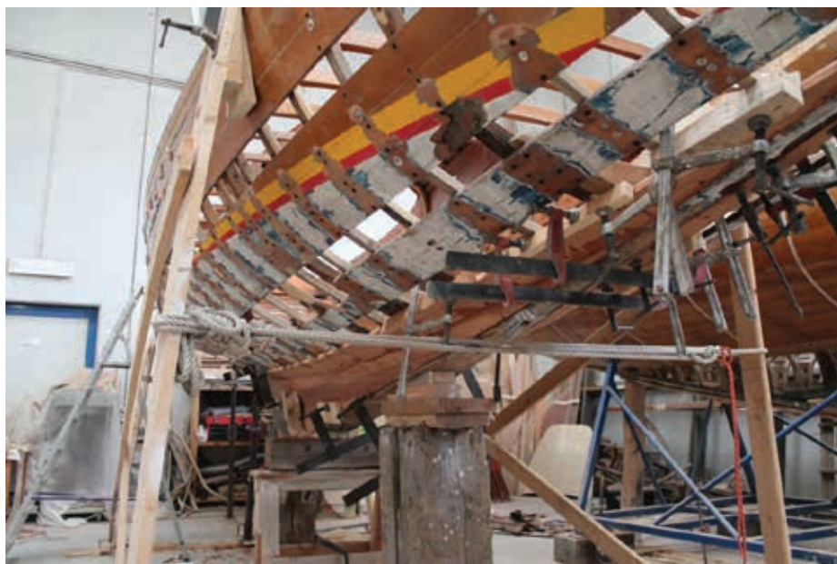
Figura 41. Fase di sostentamento e correzione dei cedimenti presenti (e potenziali anche a causa della rimozione della coperta) di un'imbarcazione della classe Dragone. Lo stato di degrado unito all'estrema leggerezza delle strutture dell'imbarcazione hanno imposto un'accurata attività di stabilizzazione durante tutte le fasi di esecuzione dell'intervento. Sono chiaramente visibili le tacche di sostentamento della chiglia, le tavole di sostegno della cinta collegate tra loro per garantire stabilità all'insieme della struttura.
