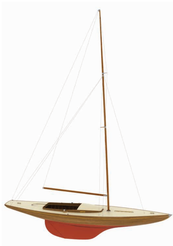
In figura sono illustrate le componenti dell'armo. Albero (1), boma (2), crocette alte (3), crocette basse (4), sartieme (5).
