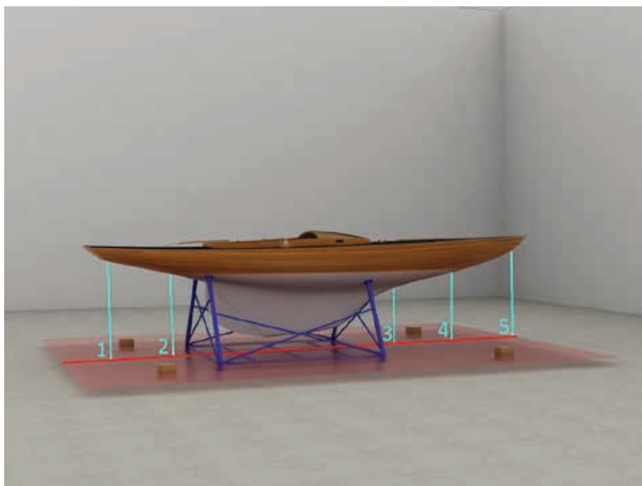
Figura 36. La preliminare verifica delle distanze (1, 2, 3, 4) tra profilo inferiore della chiglia e piano A per le successive fasi di quantificazione dell'entità delle deformazioni tramite il confronto con i disegni quotati.
