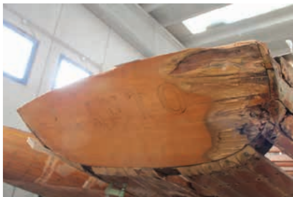
Lo specchio di poppa con gli evidenti segni di infiltrazione d'acqua piovana da coperta e ferramenta del fasciame a esso vincolate.
