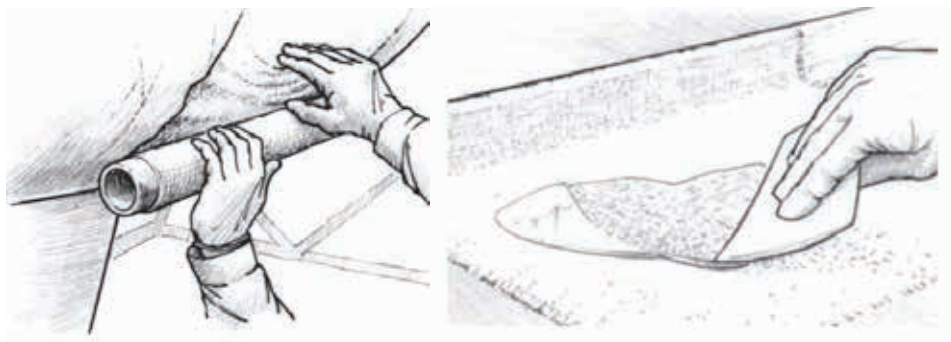
Figura 6. Rivestimento con tessuto di vetro e impregnazione con resina epossidica (Gougeon 2005, pp.126,368).
