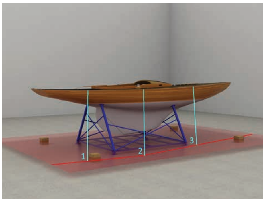
Figura 39. La preliminare verifica delle distanze (1, 2, 3) tra il bordo superiore della cinta e il piano A per le successive fasi di quantificazione dell'entità delle deformazioni tramite il confronto con i disegni quotati.
