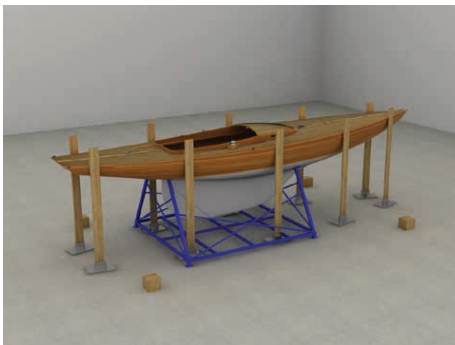
Figura 40. La fase di correzione delle deformazioni tramite sollevamento delle zone soggette a cedimenti per mezzo di puntelli regolabili in altezza. I puntelli possono essere realizzati con tavole in legno. Un'efficace sistema, nel caso di assenza della coperta, è l'utilizzo di morsetti per vincolare all'altezza corretta il complesso cinta-dormiente. Nel caso in cui la coperta sia ancora in opera possono essere utilizzate delle ferramenta passanti sfruttando i fori di ferramenta originali già presenti in opera.
