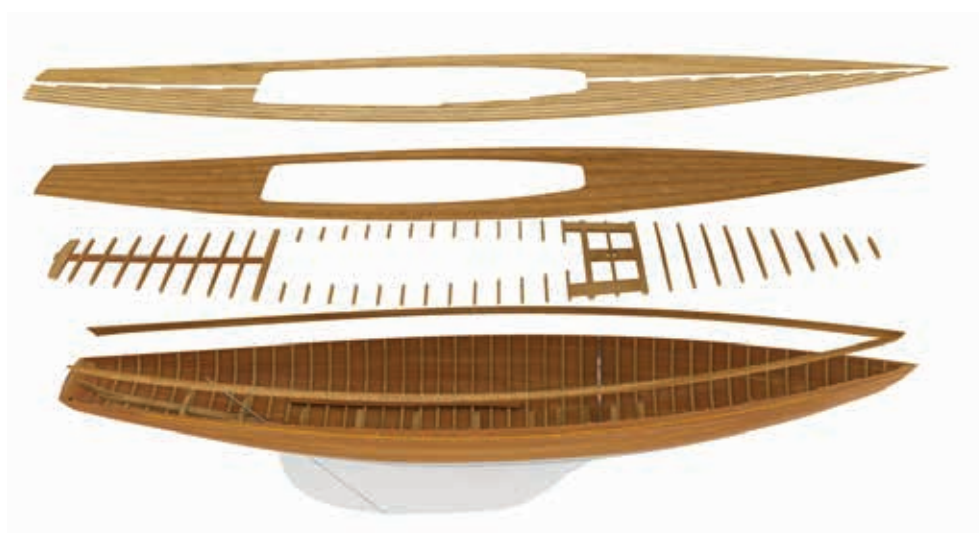
Nella figura sono visibili le strutture del ponte di coperta. Dormiente (1), bagli (2), mezzibagli (3), riempimento (4), compensato marino (5), doghe in teak massello (6).
