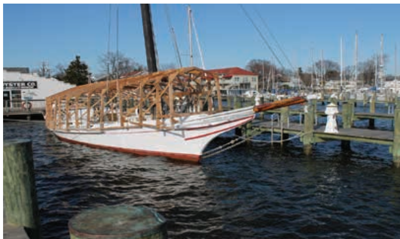
Figura 22. Imbarcazione del tipo skipjack in fase di stabilizzazione in acqua presso i pontili del Chesapeake Bay Maritime Museum (Annapolis, Maryland USA). Sono chiaramente visibili le strutture di legno predisposte per sorreggere il sistema di copertura della coperta.
