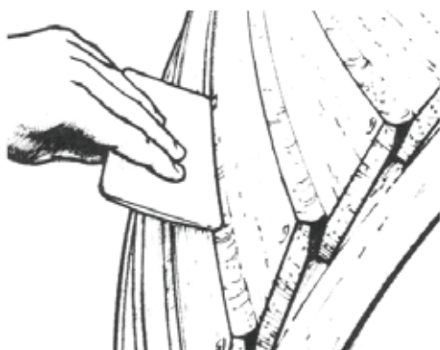
Figura 7. La cordonatura di uno scafo a clinker (Gougeon 1990, p.50).
