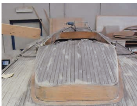
Il rivestimento del celino della tuga in doghe. In figura sono anche visibili le alzate della tuga in buono stato di conservazione.
