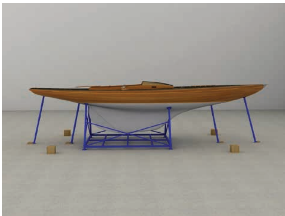
Figura 37. La fase di correzione delle deformazioni tramite puntellamento della chiglia.
