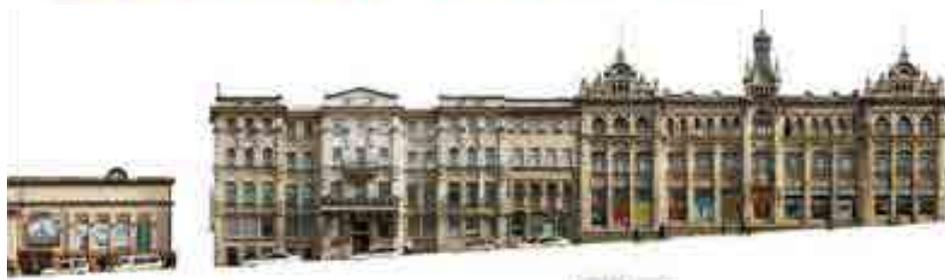
Sperimentazione di rilievo urbano con tecnica laser scanner mobile a Concordia sulla Secchia (MO) e restituzione del fronte stradale. Eseguito in collaborazione dal LaboRA (UniFE), Cristian Boscaro (Leica) e Paolo Uccelli (Leica).
