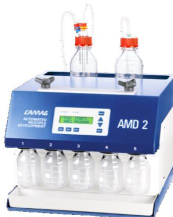
**Figure 1.5.2** *AMD apparatus.*
