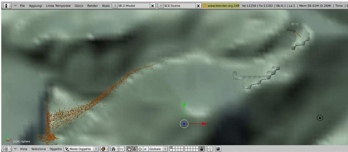
Fig. 7.23 – Simulazione della frana di Olvera al tempo t2 (7 min. - 0,8 m/s)
