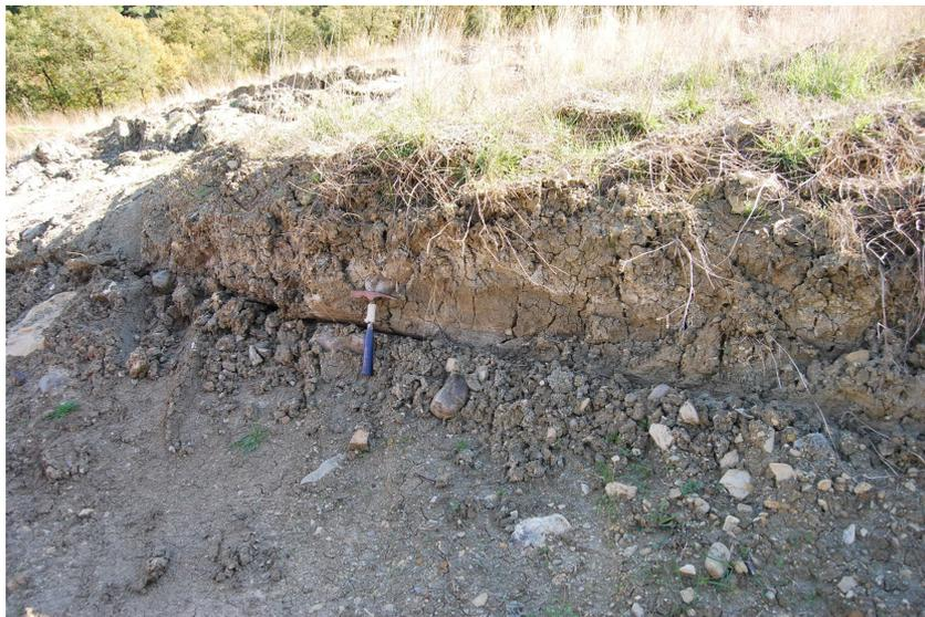
Fig. 7.3 – Superficie di separazione della colata superiore.
