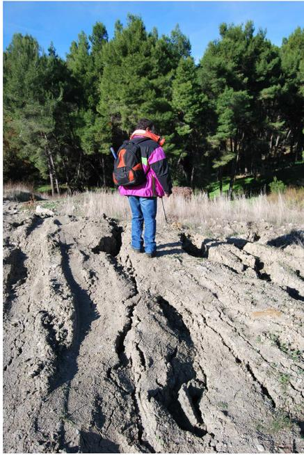
Fig. 7.6 – Transverse cracks sul corpo principale.
