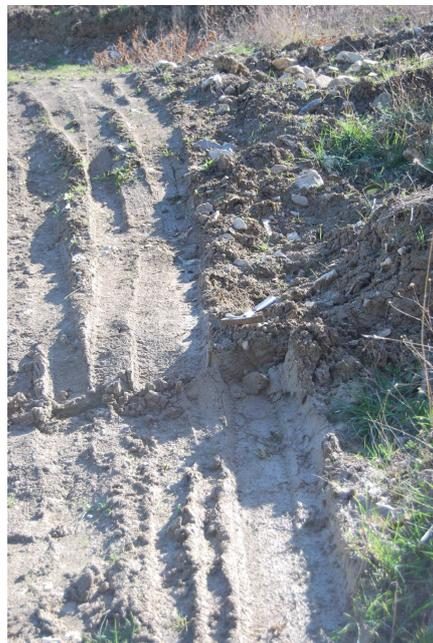
Fig. 7.5 – Spostamento centimetrico della superficie di separazione della colata superiore.
